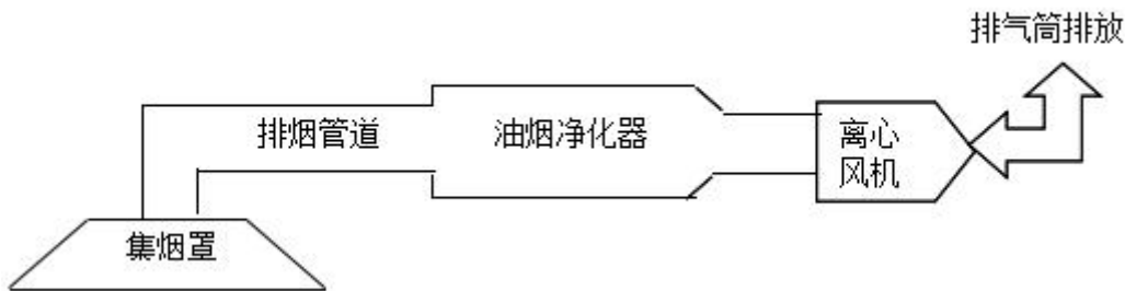
图 3 静电式油烟净化工艺图
